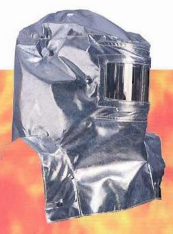
Cappuccio: di foggia ampia, idoneo per l'impiego con maschera pienofacciale e gruppo erogatore, munito di elmetto antinfortunistico a norma EN-397 classi -20°C -440 Vac, visore in vetro temperato dello spessore di 5 mm ricoperto esternamente in oro antiabbagliante, bretelle sottoascellari elastiche regolabili per un miglior posizionamento del cappuccio.
