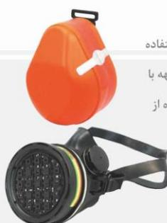
ماسک از نوع نیم صورت ساخته شده از جنس لاستیک نسوز که با فیلتر P3 برای آتش سوزی های جنگلی، با فیلتر ABEK15 برای استفاده در شرایط اضطرار تماس با گازهای اسیدی، بخارات قلیانی، مواد آئی و دی اکسید سولفوره و نیز همراه با فیلتر ABEKP15 برای مواجهه با شرایط اضطراری انتشار آلاینده های گازی و ذره ای به ویژه در عرصه صنایع شیمیائی، نفت، گاز و پتروشیمی میباشد. طول دوره استفاده از این ماسک در شرایط اضطرار بین ۱۵ الی ۳۰ دقیقه می باشد.
