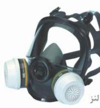
ماسک تمام صورت دوفیلتر قابل استفاده با فیلتر های CLASS1 سیک و راحت با وزن تقریبی ۴۲۰ گرم با قابلیت بالا جهت فیلتراسیون گازهای شیمیایی با بدنه ای از جنس Elastomeric دارای چهار نقطه اتصال برای ایجاد تعادل بهتر بر روی صورت . دارای لنز پلی کربنات جهت ایجاد میدان دید ۱۸۰ درجه ای ، ضد خش ، مقاوم در برابر کلیه مواد شیمیایی ، ضربه و حرارت .
