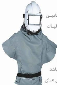
سرپوش شن پاشی (سند بلاست) مناسب برای تامین مداوم هوای تنفسی مورد نیاز ایزیتور ها در عملیات شن پاشی و با فعالیتهای مشابه استفاده میگردد. از طریق استفاده از این سیستم که مجهر به کلاه خود سبک از جنس ABS بوده و با پوشش کامل بخش فوکانی بدن که از جنس PVC منعطف میباشد میتوان برای حفاظت شاغل در مواجهه با توکش های فرسایشی ذرات شن و یا ساقمه های فولادی و غیره محافظت نمود.
