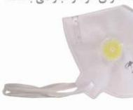
بدنه ماسک مشتمل از ۵ لایه میباشد: یک لایه فیلتر ۱۷ گرمی ملت بلون، یک لایه اسپان باند ۳۰ گرمی و یک لایه اسپان باند ۳۰ گرمی سوپاپ از جنس پلی اتیلن و به صورت چفت شونده میباشد و با دوخت التراسونیک بر روی ماسک نصب میگیرد.
