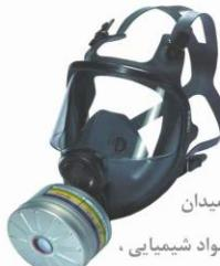
ماسک تمام تک فیلتر صورت سیک و راحت با وزن تقریبی ۴۵۰ گرم با قابلیت بالا جهت فیلتراسیون گازهای شیمیایی با بدنه ای از جنس Elastomeric دارای چهار نقطه اتصال برای ایجاد تعادل بهتر بر روی صورت . دارای ویژور پلی کربنات جهت ایجاد میدان دید ۱۸۰ درجه ای ، ضد خش ، مقاوم در برابر کلیه مواد شیمیایی ، ضربه و حرارت ، قابل تغییر کاربری از حالت اتصال فیلتر به سیستم SCBA و یا سایر سیستم های هوارسان.
