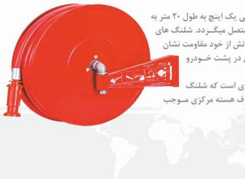
یکی از ابزارهای مناسب برای رساندن آب به محل مورد نظر است. که معمولاً شلنگ های لاستیکی یک اینچ به طول ۲۰ متر به روی آن قرار میگیرد که شلنگ از یک سر به لوله مغزی هوزیل و از سر دیگر به یک نازل فوگ متصل میگردد. شلنگ های لاستیکی در برابر احساس تیز و بزنده مقاوم می باشد. همچنین قرقره هوزیل در برابر شعله های آتش از خود مقاومت نشان داده و دچار سوختگی و از بین رفتگی نمی شود. معمولاً با استفاده از یک نازل فوگ این محصول در پشت خودرو آتش نشانی نصب می گردد.
