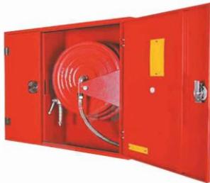
جعبه آتش نشانی دوقلو روی کار و توی کار با ابعاد ۹۰ در ۷۵ و عمق ۲۰ سانتی متر ، تولید شده از ورق های مرغوب نمره یک ، که با لایه ای از رنگ های پودری و استاتیک پوشیده شده و نوار لاستیکی دور تا دور درب ها آب بندی شده است.
