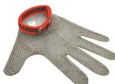
تولید شده از رینگ های 4.2 mm که از جنس فولاد مقاوم ضد زنگ ( استنلس استیل ) میباشد. طراحی ارگونومی به گونه ای میباشد که به راحتی تمام افراد راست دست و چپ دست میتوانند از آن استفاده کنند. تولید تورهای فلزی این دستکش ها به صورتی میباشد که هر حلقه به حداقل چهار حلقه مجاور خود متصل میباشد تا فاصله هایی را که چاقو می تواند نفوذ کند به حداقل برساند. تمامی دستکش های معتبر تولید شده با این مشخصات بایستی دارای استاندارد En1082 باشند.
