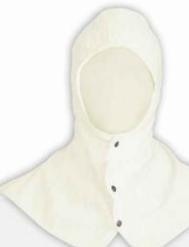
طراحی به صورت مقتنه با پوشش کامل ، تولید شده از جنس کتان با درصد خلوص پنهانی از بالا که مقاومت حرارتی خوبی از خود نشان داده و کند سوز میباشد. در ناحیه کلاه دارای آستر نخی بوده و همچنین بوسیله ی کش دوخته شده در لبه قسمت فوقانی ، مقتنه دور صورت کاربر گستر میگردد. پوشش کامل سر و گردن و نواحی بالایی از سرپوشانه که از برخورد زرات متساعد شده از جوشکاری و برشکاری جلوگیری میکند. کلاه فوق از زیر گلو به صورت دکمه ای بسته می شود. لازم بذکر است این محصول با متريال سفارشی هم تولید میگردد.
