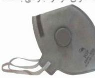
بدنه ماسک مشتمل از ۵ لایه میباشد: یک لایه فیلتر ۱۷ گرمی ملت بلون، یک لایه SMS ۳۰ گرمی، دو لایه اسپان باند ۳۰ گرمی و یک لایه اسپان باند ۳۰ گرمی سوپاپ از جنس پلی اتیلن و به صورت چفت شونده میباشد و با دوخت التراسونیک بر روی ماسک نصب میگیرد.
