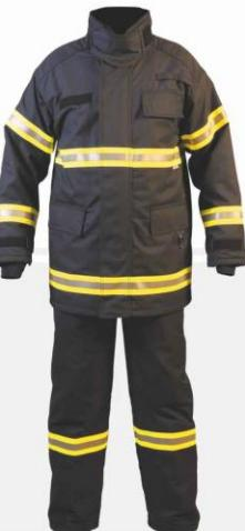
لباس فوق به صورت اورکت و شلوار طراحی و از ترکیب ذیل تولید شده است: لایه بیرونی لباس: از جنس نومکس (۷۵٪ از NOMEX و ۲۳٪ از KEVLAR P140). لایه ضد رطوبت: از پارچه با الیاف بافت شده مقاوم حرارتی و غشا PU. لایه ضد حرارت: از ۱۰۰ درصد این لایه از مواد مصنوعی آرامید ساخته شده. لایه داخلی لباس: از ۵ درصد از مواد مصنوعی آرامید آمیخته با ۵ درصد مواد ویسکوز FR.
