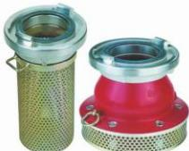
کاربرد های فراوان و تأثیر گذاری دارد به صورت مثال تخلیه آب از مکان هایی که دجاج آب گرفتگی و یا سیلاب شده، آب گیری مخازن آتش نشانی از حوضچه ها، پمپاژ مجدد آب از حوضچه هایی که گداگرد محل آتش سوزی به صورت اجرا شده است. در راستای مکش آب توسط پمپ های آتش نشانی، صافی از انسداد ناشی از ورود سنگ، تکه های کوچک از جوب و زباله های دیگر جلوگیری می‌کند. صافی مکش همه راه بادیچه تنظیم تخلیه و سوپاپ بدون بازگشت است و از آلیاز آلومینیوم یا فلز مرکب از مس و قلع و روی ساخته شده است.
