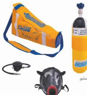
این سیستم تنفسی EEBD دارای سیلندر فولادی ۲ لیتر با قلاف شکیل ویژه بوده و تسممه های رابط کمری و شانه ای طراحی شده در آن اجازه استفاده سهل در هنگام شرایط اضطرار و فرار را بسرعت فراهم می نماید. ماسک مدل TR 2002/BN از جنس EPDM می باشد . ماسک دو منظوره بوده و علاوه بر استفاده با این سیستم کاربر را قادر می سازد که از انواع فیلتر های شیمیایی نوعی Screw نیز با این ماسک استفاده نماید . ماسک دارای لنز ضد خشی و ضد حلال با سطح %۳۰ وسیع تر از سایر مدل های تمام صورت می باشد .
